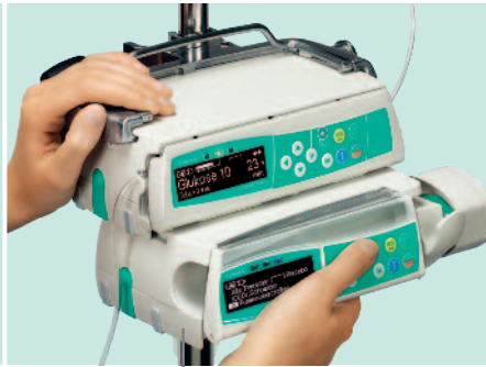
Bis zu drei Pumpen können gestapelt und transport- sicher verriegelt werden
